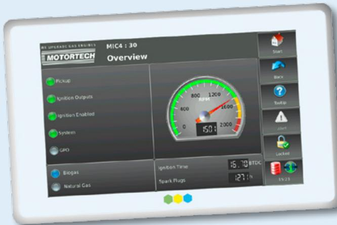
Les données d'exploitation des dispositifs de contrôle d'allumage du MIC4 peuvent entièrement être visualisées au moyen d'un module HMI (interface homme machine). La feuille récapitulative montre les informations pertinentes. Le module HMI du MIC4 permet d'ajuster de nombreux paramètres d'allumage tels que le point et l'énergie d'allumage.
